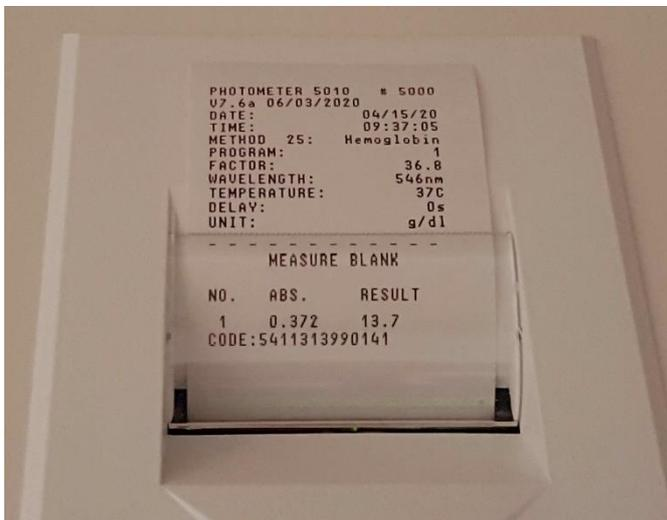
Falls kein Barcodeleser verwendet wird, aber die Funktion BARCODE EIN aktiviert ist, wird anstelle eines gescannten Barcodes ein generierter Code angezeigt:
