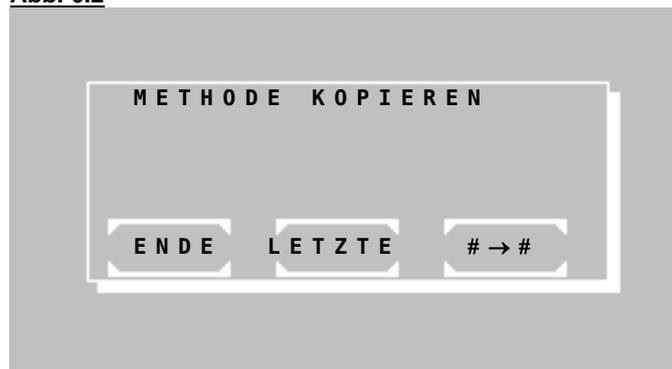
[#→#] Alle Methoden ab Nr. 20 können auf eine neue Methodennummer kopiert werden. Zuerst wird in [Abb. 6.3](#) die zu kopierende Methode abgefragt, deren Einstellparameter ab [Abb. 6.4](#) verändert werden können.
