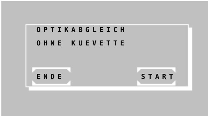
Der optische Abgleich soll nach einer Erwärmung des Geräts von 15 Minuten durchgeführt werden, besser nach einer Stunde Betriebsdauer.
