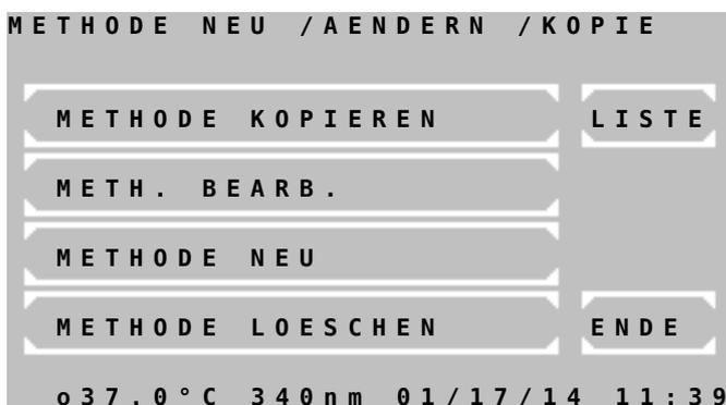
Jeder photometrischer Test kann mit seinen Einstellparametern durch den Methodeneditor dauerhaft gespeichert werden.
