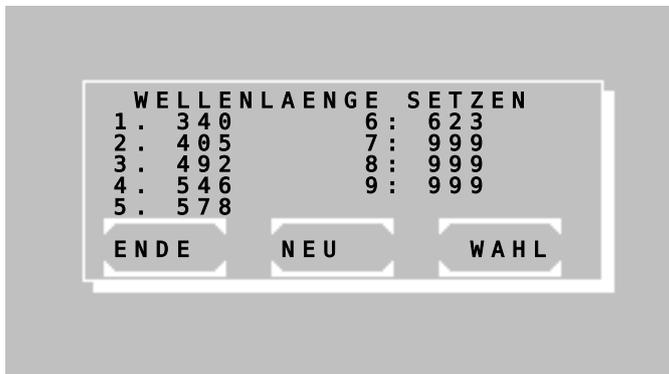
Die mit dem Photometer 680 verwendeten optischen Filter können definiert werden. Bis zu neun Wellenlängen werden gleichzeitig unterstützt.
