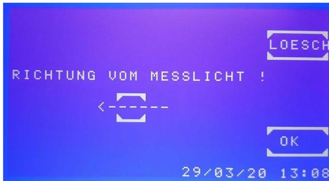
Die Richtung des Lichtstrahls (Messlicht) wird angezeigt.
