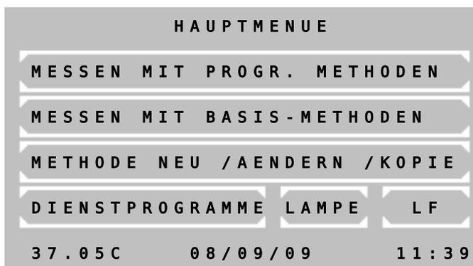
Die Betätigung der Schaltfläche [LF] im Hauptmenü führt bei aktiviertem Drucker einen Papiervorschub durch. Mehrere Zeilen können durch andauernden Druck auf [LF] weitergeschaltet werden.
