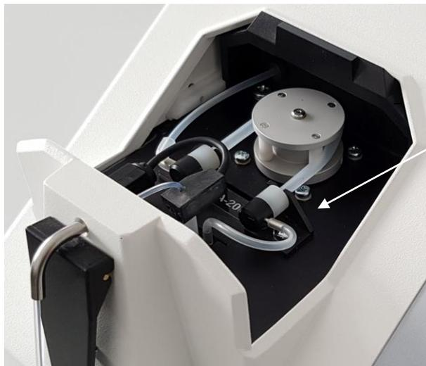
El tubo de la bomba puede ser retirado fácilmente de los soportes metálicos.
