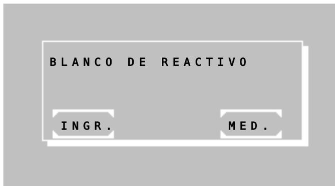
Luego de seleccionar un método con blanco de reactivo (BR), el blanco de reactivo puede ser medido, ingresado manualmente o puesto en cero.
