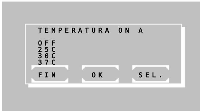
El estado actual del control de temperatura es mostrado en la primera línea como ON o como OFF. Las letras A o S indican el tipo de adaptador de cubeta usado en el momento.
