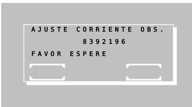
Calibración del nivel de corriente oscura.
