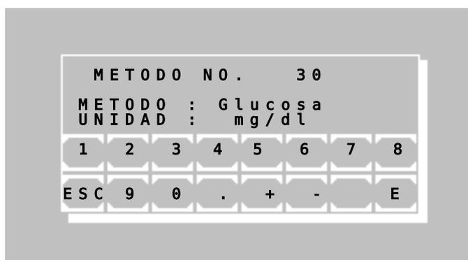
Un método programado para una prueba fotométrica puede ser llamado directamente ingresando el número del método.
