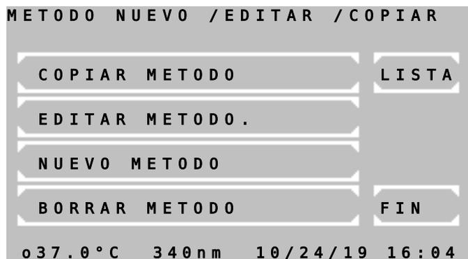
Mediante el editor de métodos es posible almacenar en la memoria del equipo cada prueba fotométrica con sus parámetros.
