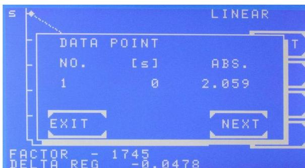
Vista secuencial de los puntos de medición después de presionar [DIAG.] y [LISTA]
